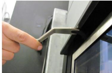
Die Seitentür zum Reinigen öffnen, indem man den Sperrhaken sowohl oben als auch unten an der Tür dreht.
